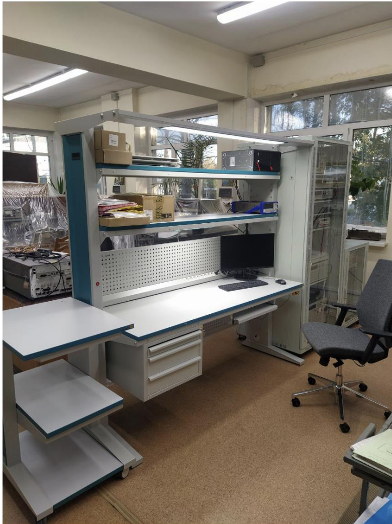
Стенд для поверки источников питания и рабочее место метролога
