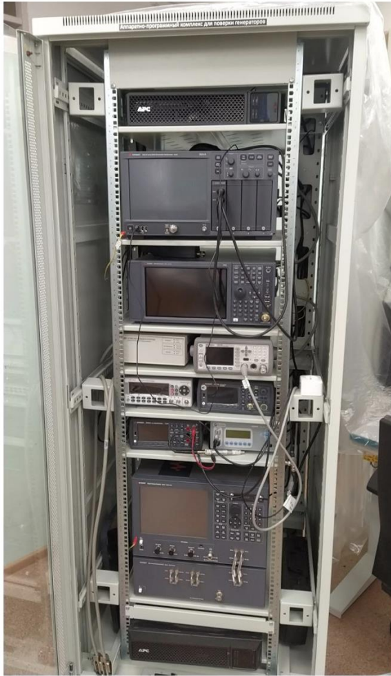
Стенд для поверки генераторов СВЧ 50 ГГц
