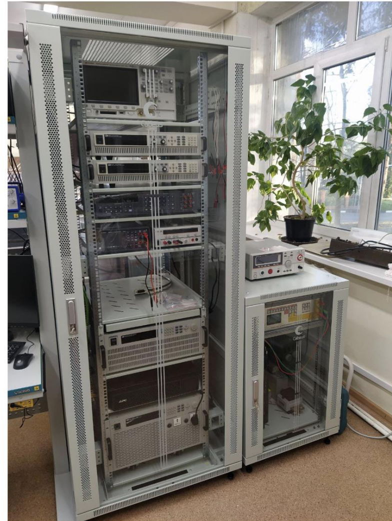
Стенд для поверки источников питания и рабочее место метролога
